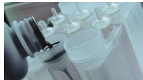
После заправки всех емкостей выньте воронки из внешних емкостей и тщательно промойте их проточной водой, чтобы сохранить воронки для дальнейшего использования. Затем закройте отверстия для заливки чернил цветной резиновой заглушкой из комплекта прилагающегося к СНПЧ.
